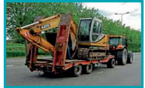
Lading mag niet meer dan 5,00 meter achter de achterste as uitsteken.
