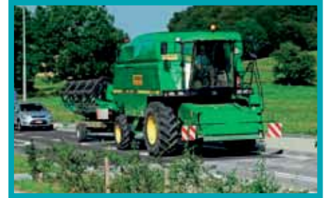
Deze maaidorser kan niet harder dan 30 km/h en moet een bedrijfsrem hebben met een remvertraging van ten minste 2,4 m/s 2 .
