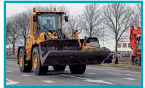
Een wielladerbak is een verwisselbare uitrustingsstuk. Bij meer dan 10 cm uitsteken (buiten de banden) moet de bak worden gemarkeerd.
