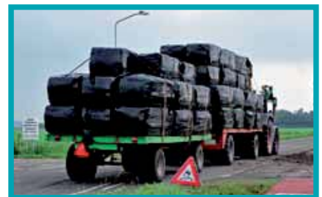
Lading moet goed zijn gezekerd. Bij plotseling manoeuvres mag de lading niet van het voertuig kunnen vallen of glijden.
