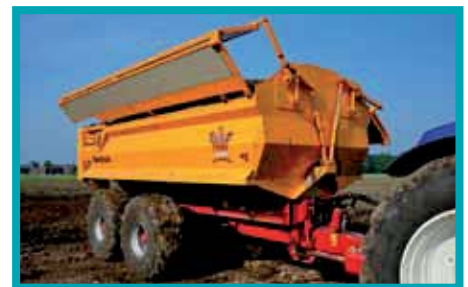
Losse lading waarbij het gevaar bestaat dat deze af kan vallen, moet goed zijn afgedekt.
